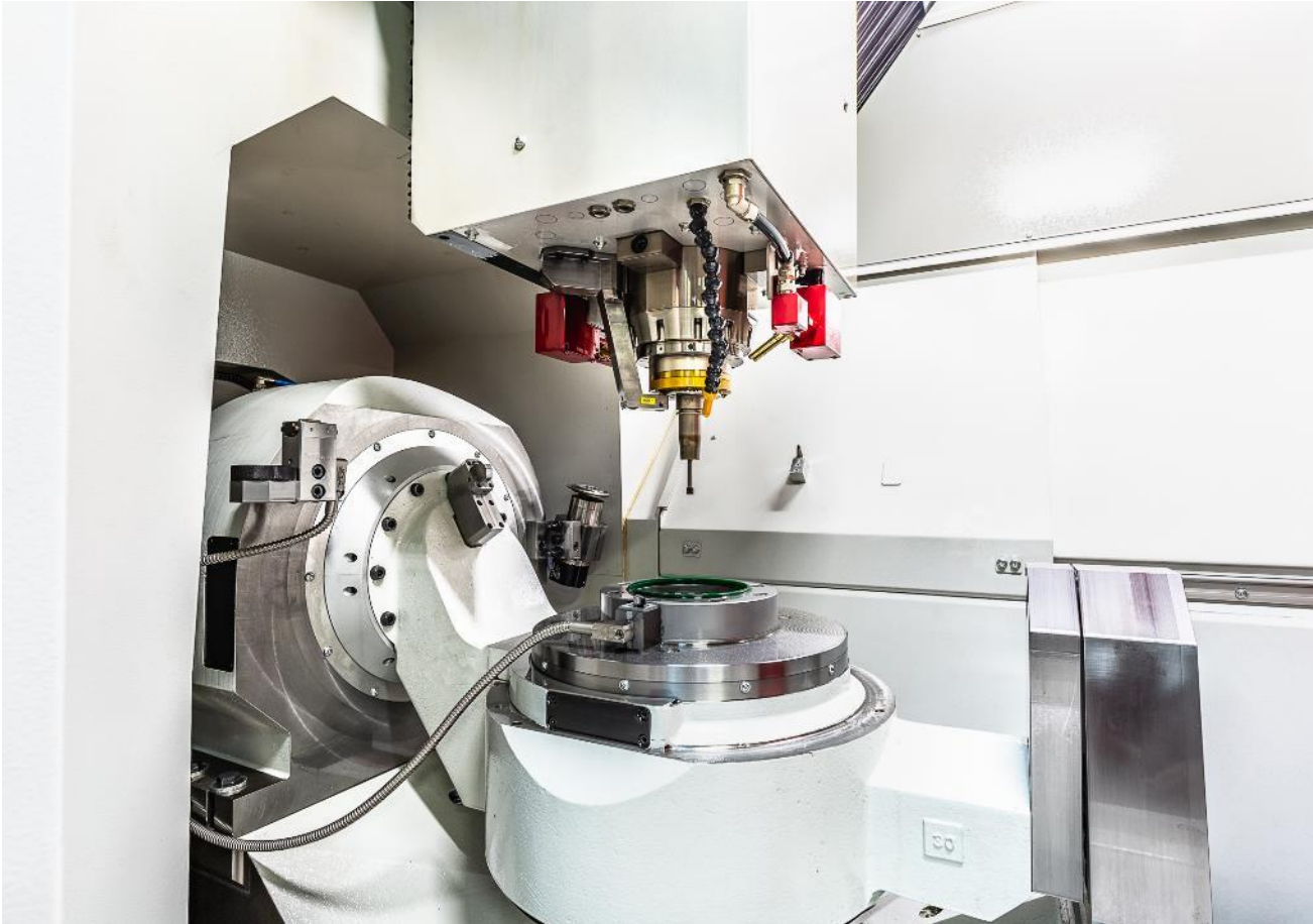
Abb. 2: Der Entfall des Aus- und Einspannens der Hartmetallwerkstücke zum Prüfen maximiert die Präzision.
