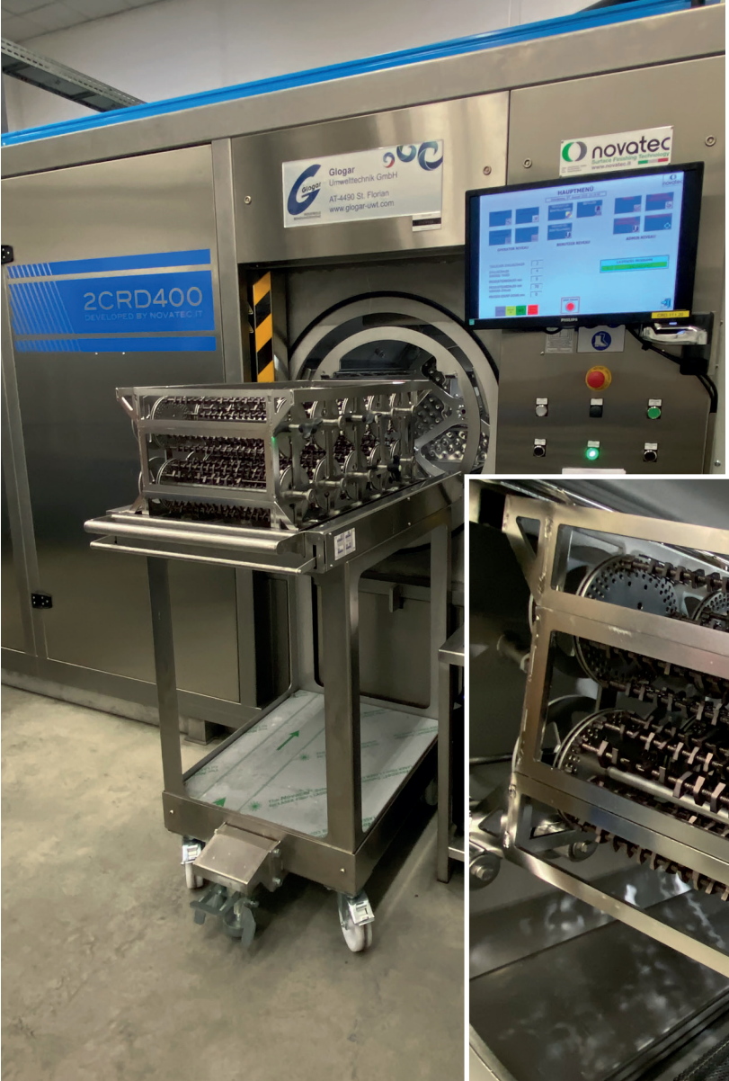
Mit der Reinigung steht und fällt die Qualität der PVD-Beschichtung. Die im August 2020 in Betrieb genommene Glogar/Novatec Ultraschall-Reinigungsanlage sorgt für die absolute Reinheit und eine optimal benetzbare Oberfläche als Vorbehandlung vor dem PVD-Beschichtungsprozess.
