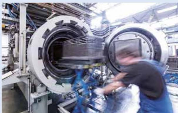
Der typisch metallische Charakter der Werkstücke entfaltet sich beim darauffolgenden Flüssigphasensintern. Dies erfolgt unter einer kontrollierten Ofenatmosphäre bei Temperaturen von 1350°C - 1500°C sowie unter Druck von 100 bar in den Sinter-HIP-Anlagen. Besonders bei feinstkörnigen Sorten und Kobaltgehalten unter 15 % erreicht man dadurch eine deutliche Steigerung der Biegebruchfestigkeit.
