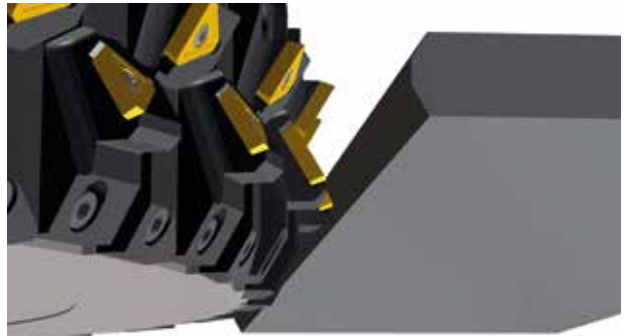
I + V-Profil = X-Profil mit 2 seriellen Fräsern I + V-profile = X-profile with 2 serial cutters
