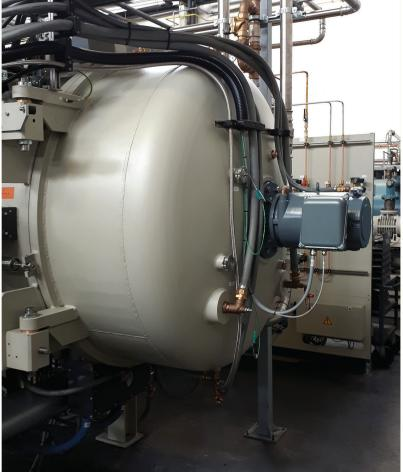
Der integrierte Wärmetauscher der neue Vakuumsinteranlage bietet eine höhere Kühlleistung The integrated heat exchanger of the new vacuum sintering system offers a higher cooling capacity
