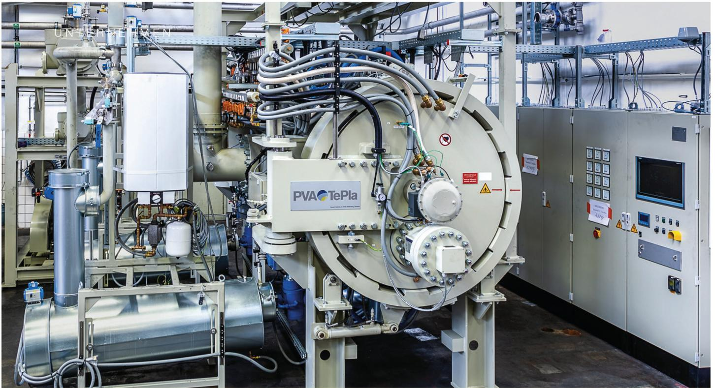
Die neue Druck Sinteranlage mit zwei Entwachsungsstrecken aus Edelstahl zur gleichmäßigen und schnellen Entbindung
