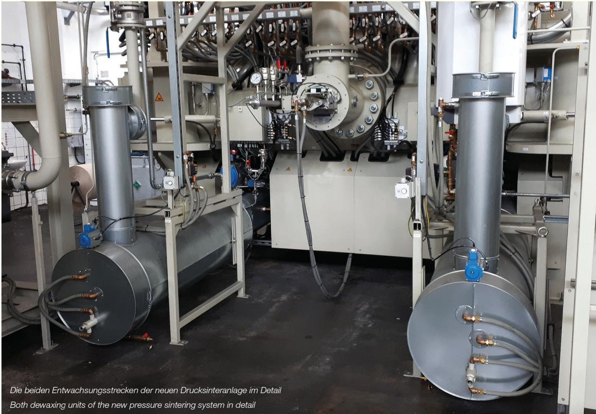
*Die beiden Entwachsungsstrecken der neuen Drucksinteranlage im Detail
